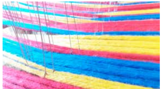
Alumna Bianca Ojeda. Urdimbre en el telar: distribución de hilos de urdimbre en las mallas de los lizos.
